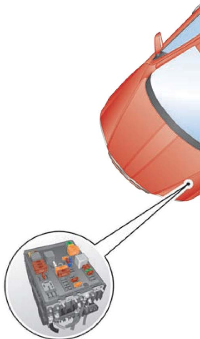
Elektrik-Box im Motorraum (E-Box)
